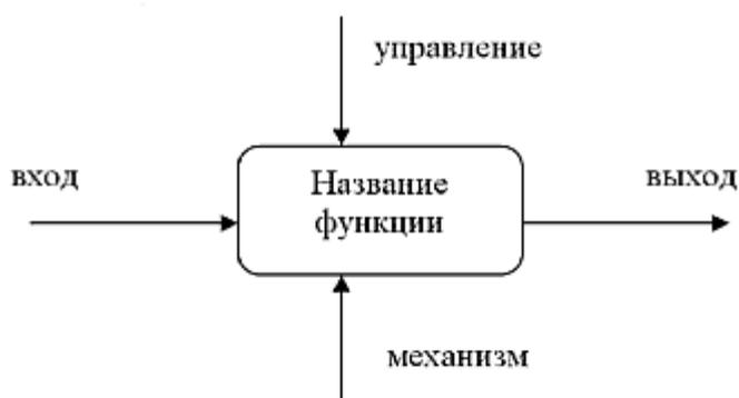
Рис. 1.3. Схема моделирования SADT [179].
